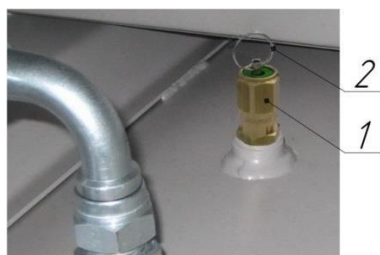
Рисунок 9 – Клапан предохранительный пружинного типа
