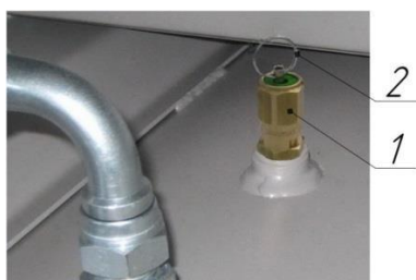
Рисунок 8 – Клапан предохранительный пружинного типа
